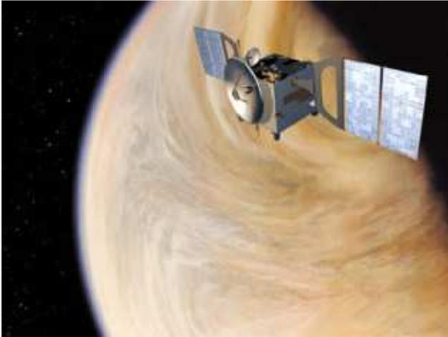
Venus Express はヨーロッパ宇宙機関が推進する金星探査計画です。2005年11月に衛星の打上げられ、2006年4月に金星周回軌道(極軌道)に投入されました。現在、金星周回軌道上から、リモートセンシングによって主に大気組成の観測や、金星周辺に広がる電離大気も調査しています。既に打ち上げられた火星探査機 Mars Express の設計をベースにすることによってコスト削減や開発期間の短縮を狙ったため、搭載観測機器(以下)も Mars Express と共通のものが多くなっています。
