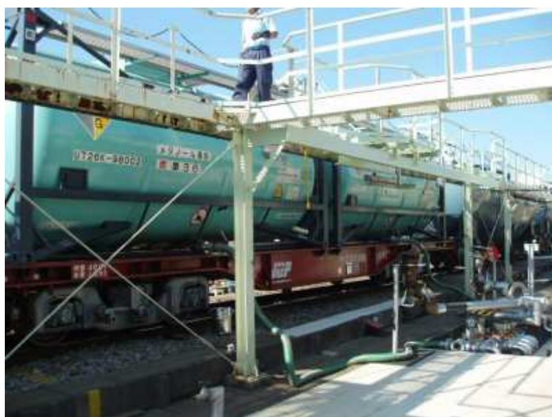
OT高崎営業所内のメタノール取卸作業
